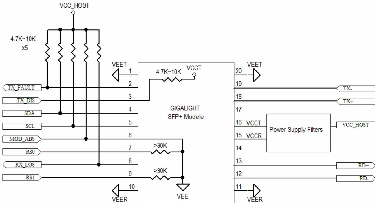
Figure4. Host-Module Interface
